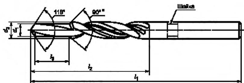
\* Допускается изготовление сверла с углом  $120^\circ$ .
