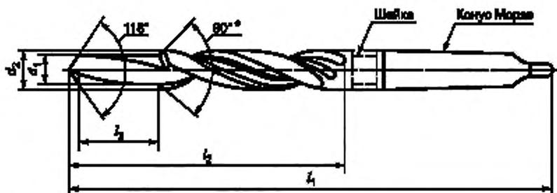
\* Допускается изготовление сверла с углом  $120^\circ$ .
